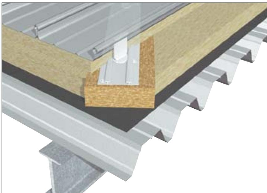
A primeira linha de clips é alinhada com precisão onde se vai começar a montagem (empena) e aparafusada ao carril através das suas bases. Os restantes clips são inseridos no carril e as suas cabeças ficam paralelas ao sentido do rebordo da bandeja Kalzip. Cada decima fila de clips é aparafusada ao carril para evitar que deslizem.
