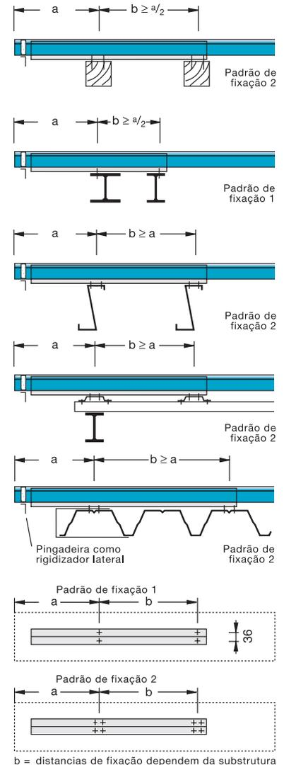
b = distancias de fixação dependem da substrutura
