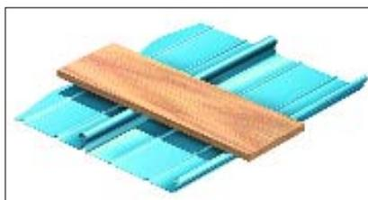
passagem ou para transporte dos materiais de montagem deverão ser protegidas com passadeiras temporárias (tábuas), sendo estas passadeiras fixas com os acessórios de passadeira para evitar que escorreguem.
