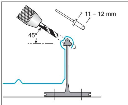
na zona de ponto fixo para evitar que deslize. Em coberturas de baixa pendente até 5 graus de inclinação e em que as bandejas não excedam 25 metros de comprimento, o seguinte método de ponto fixo é normalmente recomendado. Primeiro é feito um furo na cabeça do clip atravessando o rebordo pequeno da bandeja e coloca-se um rebite cego.
