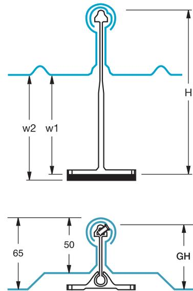
H = altura do clip sem a base de corte térmico
