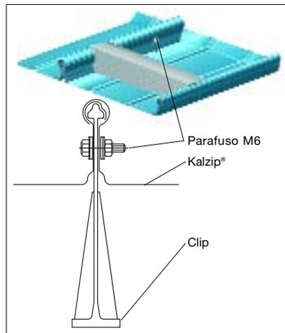
O ponto fixo não pode ser criado através da colocação de um rebite na cabeça do mesmo, mas somente por um parafuso a atravessar a parede das bandejas e a falange do clip. Deverão ser colocadas anilhas em ambos os lados da bandeja (cabeça do parafuso e porca). A localização e tipo de ponto fixo deverão estar definidos nos planos de montagem.
