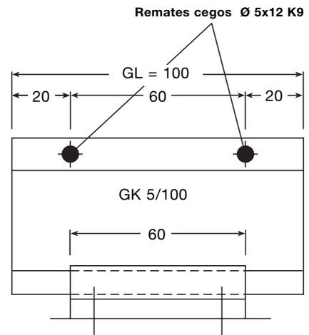
O clip de dilatação (aqui demonstrado o GK5/100) tem de ser fixo com dois rebites cegos Ø 5 x 12 K9 ao rebordo pequeno da bandeja.
